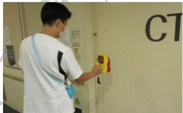
CT撮影装置の漏れる線量を測る様子
